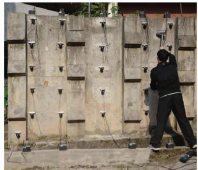
(b) 环境激励下的挡墙振动测试
